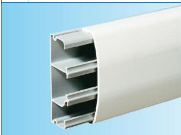
Canalina tipo Bocchiotti o similare con funzioni porta apparecchi e portacavi, realizzata in PVC rigido non propagante la fiamma, idonea per installazioni a battiscopa, parete e soffitto di impianti elettrici e/o sistemi di comunicazione con tensioni fino a 1000 V in corrente alternata e/o 1500 V in corrente continua e certificata da IMQ secondo la norma EN 50085.
