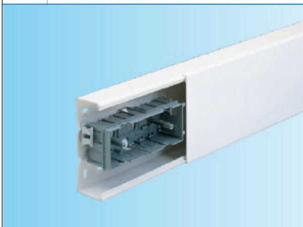
Canalina tipo Bocchiotti o similare con funzioni portacavi e porta apparecchi, realizzata in PVC rigido non propagante la fiamma, idonea per installazioni a parete e soffitto di impianti elettrici e/o sistemi di comunicazione con tensioni fino a 1000 V in corrente alternata e/o 1500 V in corrente continua e certificata da IMQ secondo la norma EN 50085.
