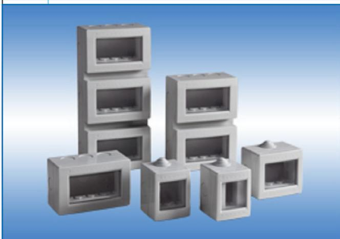
Contenitore stagno porta apparecchi tipo Bocchiotti o similare, realizzato in materiale termoplastico, idoneo al contenimento di dispositivi di comando, prelievo energia e protezione per installazioni elettriche fisse ad uso domestico e similari, in ambienti con temperatura compresa fra  $-25^{\circ}\text{C}$  e  $+60^{\circ}\text{C}$ , e certificato da IMQ secondo la norma EN 60670-1.
