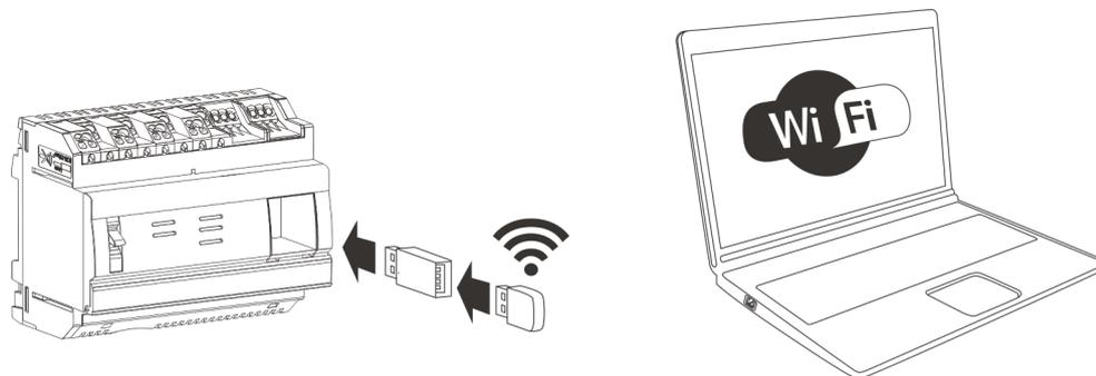
L'adattatore Wi-Fi HTG460H (Dongle) è un'interfaccia Wi-Fi - USB particolarmente adatta a una connessione senza fili con l'HTG410H. Offre una connessione diretta nella parte anteriore, senza che quindi occorra rimuovere il coperchio. Si tratta del metodo più semplice per connettere un computer o un tablet.
