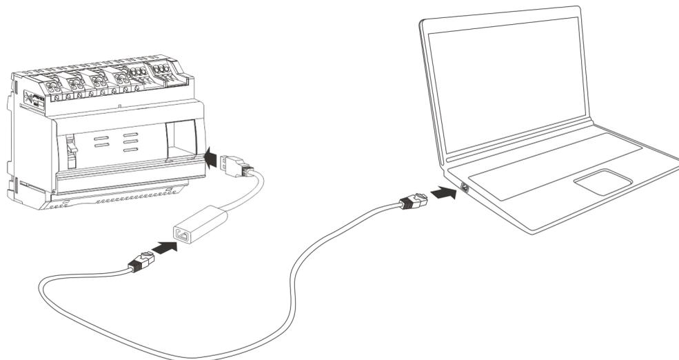
L'HTG457H è un'interfaccia USB- Ethernet RJ45 particolarmente adatta per una connessione locale con il server di energia se si utilizza un computer. L'HTG457H offre una connessione diretta nel pannello anteriore, senza che quindi occorra rimuovere il coperchio.
