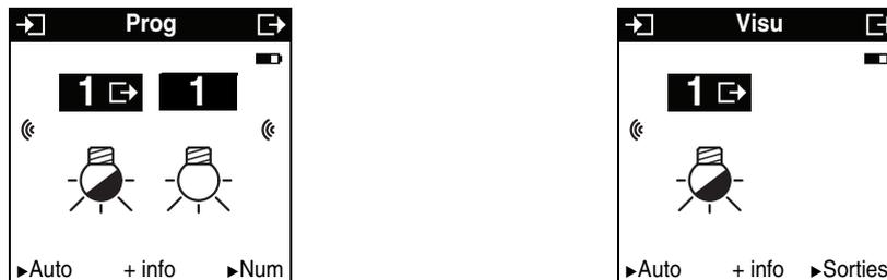
Le mode +Info permet de lier l'indication d'état d'une sortie à un produit de visualisation : Contrôleur d'ambiance, sortie de type voyant, etc.
