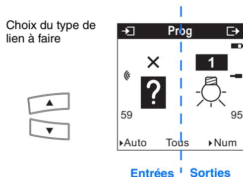
Le symbole indique qu'il s'agit d'entrées radio. Pour sélectionner les fonctions, il faut aller dans le mode numérotation.
