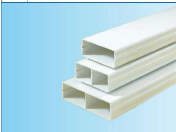
Canalina tipo Bocchiotti o similare con funzioni portacavi, realizzata in PVC rigido non propagante la fiamma, idonea per installazioni sottopavimento incassato in soletta di cemento di impianti elettrici e/o sistemi di comunicazione con tensioni fino a 1000 V in corrente alternata e/o 1500 V in corrente continua e certificata da IMQ secondo la norma EN 50085.
