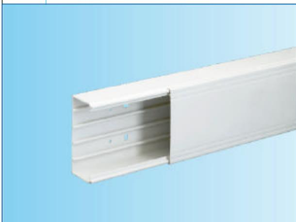
Canalina tipo Bocchiotti o similare con funzione portacavi, realizzata in PVC rigido non propagante la fiamma, idonea per installazioni a parete e soffitto di impianti elettrici e/o sistemi di comunicazione con tensioni fino a 1000 V in corrente alternata e/o 1500 V in corrente continua e certificata da IMQ secondo la norma EN 50085. Canalina completa di componenti ed accessori per ridurre al minimo lavorazioni e adattamenti in opera.
