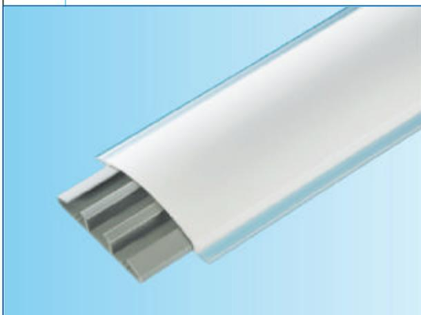
Canalina tipo Bocchiotti o similare con funzioni portacavi, realizzata in PVC rigido non propagante la fiamma, idonea per installazioni sopra-pavimento di impianti elettrici e/o sistemi di comunicazione con tensioni fino a 1000 V in corrente alternata e/o 1500 V in corrente continua e certificata da IMQ secondo la norma EN 50085.
