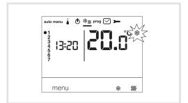
In modalità HE, fare attenzione a commutare la pompa di calore in base alla modalità scelta per il cronotermostato.
