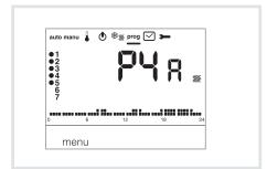
Al momento della programmazione, procedere analogamente a P4 sapendo che il cronotermostato applicherà automaticamente l'anticipo con la durata
