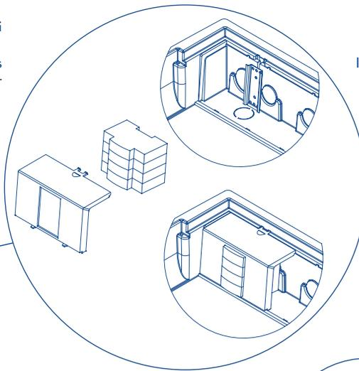
Il **CMA-4 NEST** è il supporto idoneo ad ospitare fino a **4 interruttori automatici** ad attacco Din. Il kit comprende una guida omega che si fissa con una vite nell'opportuna sede sul fianco della torretta a scomparsa ed il supporto finestrato che si fissa a scatto. A corredo sono forniti i tappi ciechi.
