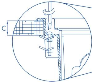
Le **4 zanche regolabili** alloggiate sui due fianchi della torretta a scomparsa NEST permettono il fissaggio della stessa al pannello del pavimento flottante o alla cassaforma di metallo nelle applicazioni in pavimenti affogati.
