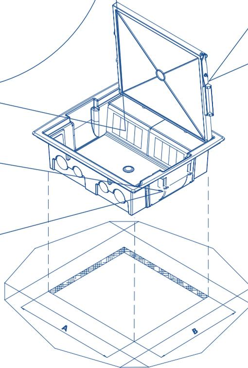
Una **leva** appositamente progettata facilita l'operazione di apertura volontaria della torretta a scomparsa NEST: una sede apposita per il posizionamento del dito della mano ne agevola l'utilizzo. Il coperchio, nel rispetto di tutte le prescrizioni normative, si chiude spontaneamente per gravità. Per smontare completamente il coperchio è sufficiente posizionarlo in prossimità della verticale e operare una trazione verso l'alto.
