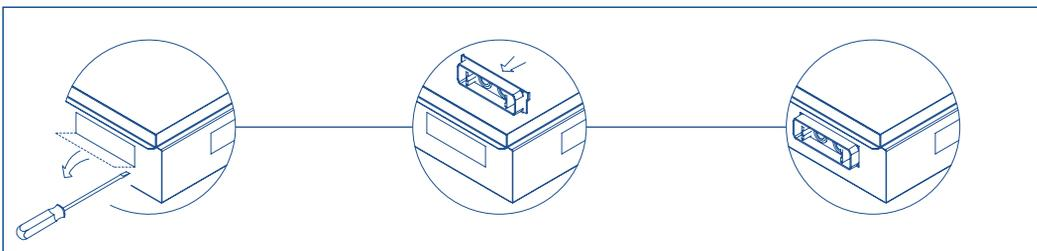
La **cassaforma** permette l'applicazione della torretta a scomparsa nel pavimento affogato. Il raccordo con i canali Metrò fast o i tubi di diametro 16, 20, 25 mm è possibile mediante le paratie fornite in dotazione: asportando con un attrezzo i fianchi pretranciati, si fissano ad incastro le paratie in plastica.
