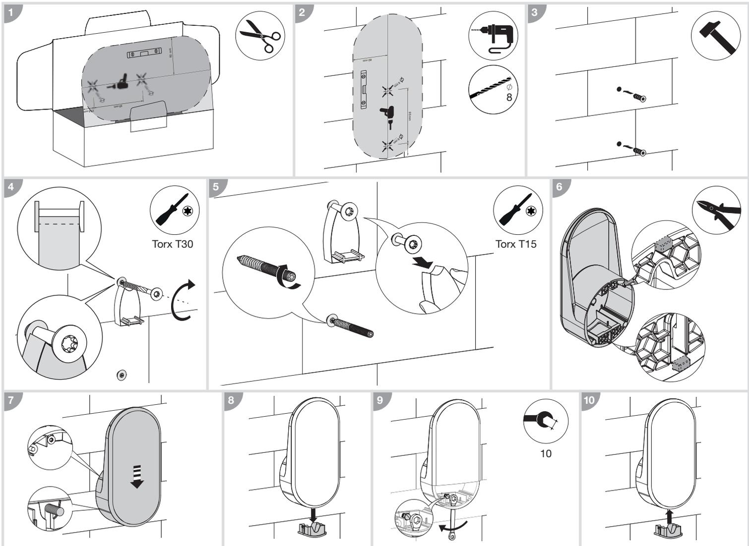
Fixation sur la borne de charge / Mounting on the charging station / Befestigung auf die Ladesäule / Fissaggio sulla stazione di ricarica
