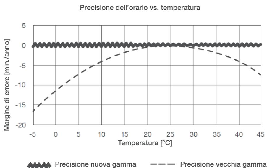
L'orologio in tempo reale integrato funziona con una precisione al secondo, in condizioni di esercizio normali. Anche a temperature estreme da  $-40\text{ }^{\circ}\text{C}$  a  $+85\text{ }^{\circ}\text{C}$ , il margine di errore è di solo  $\pm 90$  secondi all'anno.
